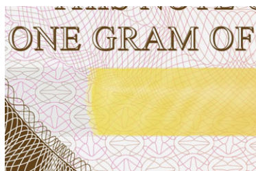
Рис.3 Элемент дизайна банкноты с золотой нитью, защищённой от истирания в полимер при помощи коронного разряда.
